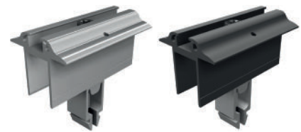
Mittelklemmen Vario mit Erdungspin für Rahmenhöhe 28 mm - 50 mm
