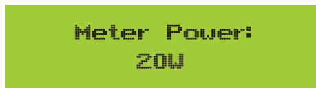
Abb. 7.36 Null-Export-Funktion über Energiezähler einschalten
